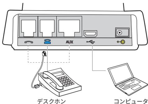
最初にデスクホンと PC ケーブルをベースに接続します。特定の電話機に関する詳細は、<http://www.jabra.com/compatibilityguide> を参照してください。
