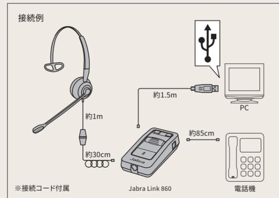
製品表面にデスクフォン/PCソフトフォンを切り替えるスイッチを配置。高性能・多機能でありながらセットアップも操作も簡単。DSP(デジタル信号処理)、通話音量を快適なレベルに自動調整するダイナミック音量コントロール、トーンコントロールイコライザー等最新のオーディオ技術を搭載し、周囲の雑音を低減しながら音声をクリアに最適化して伝達。独自の保護聴覚機能 Jabra Safe Toneを搭載し、耳に安全な音量に制御します。
