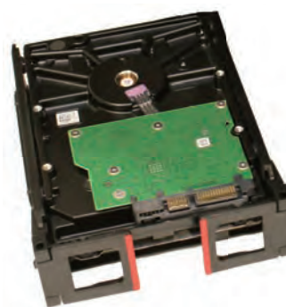
FLEXトレイ (前面結線) 3.5インチHDD装着例
