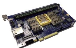
HPE SimpliVityは、ハードウェアとソフトウェアテクノロジーをバランス良く組み合わせ、本体のCPUに負荷をかけることなく最先端のデータマネジメント機能を提供します。独自の「ハードウェアアクセラレーター」による超高速インライン圧縮+重複排除や、「ハードウェアRAIDコントローラー」によるSSDへの高速書き込み/読み出しは、他のHCI製品にないユニークな特長です。
